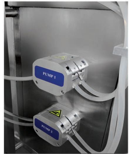
الشكل 2- رأس المضخة الأنبوبية المدمج في آلة تعبئة السوائل
