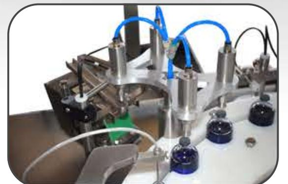
يتم تزوييد السدادات بواسطة ذراع روبوتى يعمل بالهواء المضغوط
