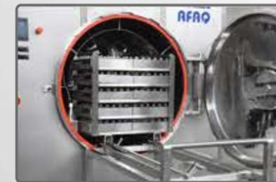
بوابات محكمة بواسطة موانع مصنوعة من السيليكون القابل للنفخ بواسطة الهواء المضغوط
